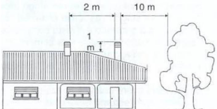
Rozměry komínu se mohou lišit v závislosti na modelu kouřovodu. Aby však byla zajištěna dobrá splynatost kouře, musí být průchod vzduchu na jeho výstupu vždy dvojnásobkem průchodu samotného kouřovodu a víko komína nesmí nikdy bránit průvanu.
