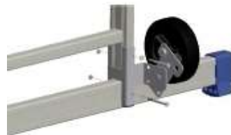
Bezpečnostní pozice koleček v případě použití rámu jako samostatného žebříku.
